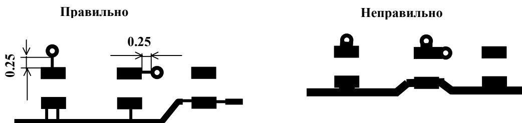
Рис. 6 Примеры расположения переходных отверстий.
